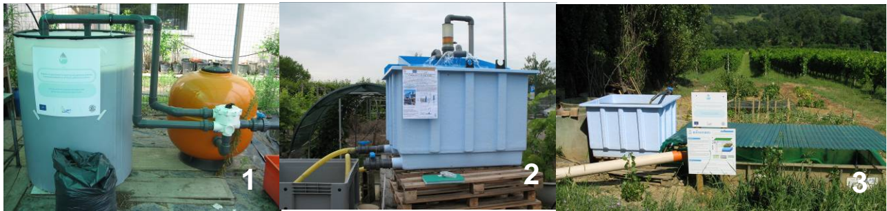
Schéma 10 : Exemples de bioréacteur ArtWET : bioréacteur à Piacenza (Italie) représenté dans sa version initiale (1) et finale (2 et 3)
