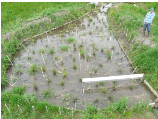
19 : Expérience de traçage dans le bassin de rétention d'Eichstetten (ZHA4)
