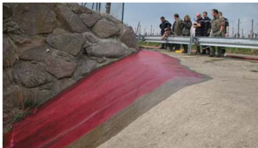
Traçage sur le bassin d'orage de Rouffach (France). Rhodamine à l'entrée du bassin, mars 2007
