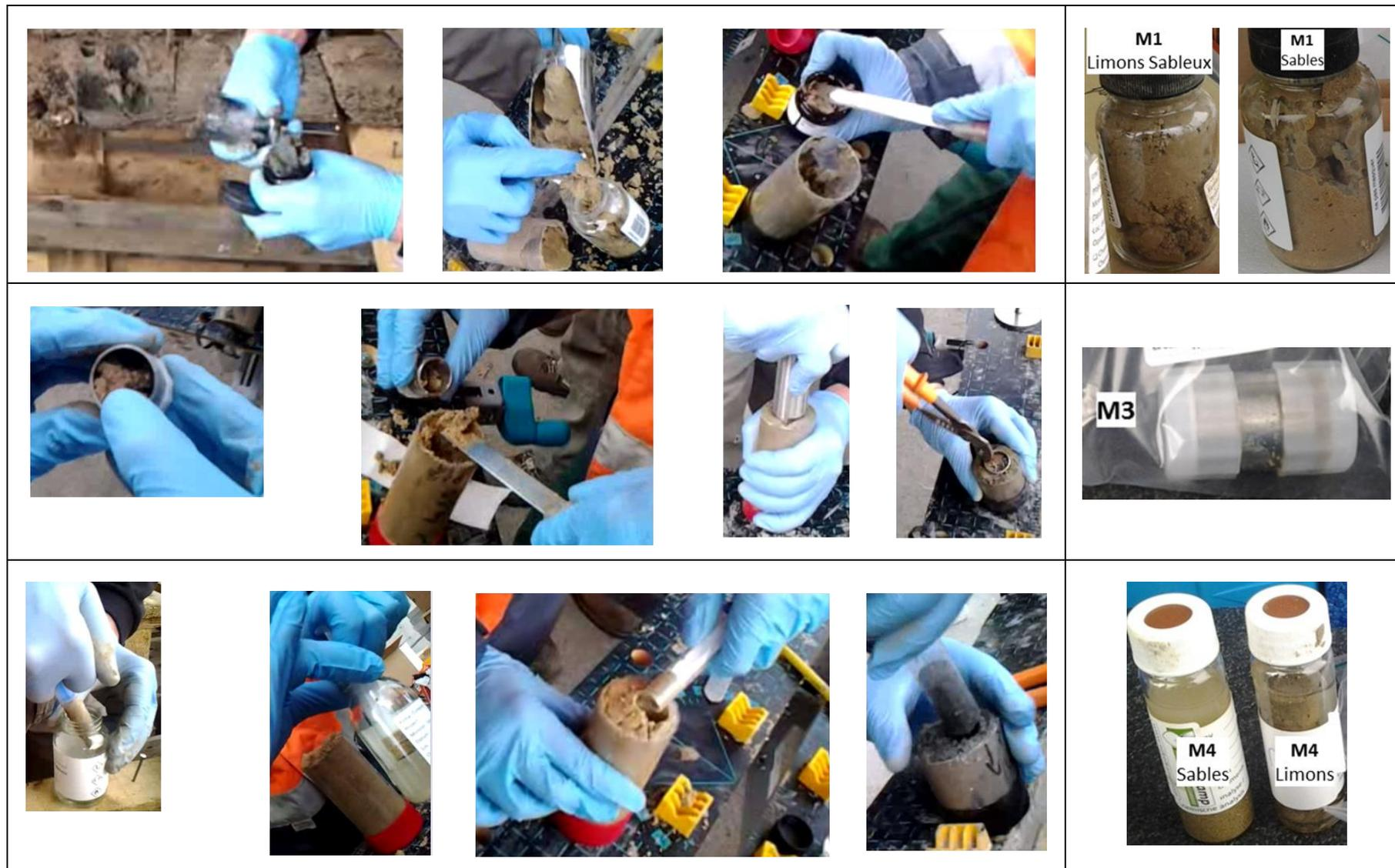
**FIGURE 5 – ILLUSTRATION DES ETAPES DE PRELEVEMENT DES ECHANTILLONS POUR LES TROIS METHODES ET EXEMPLES DE CONDITIONNEMENTS : M1 – POT BRUT (EN HAUT), M3 – SOIL CORER 16mL (AU MILIEU), M4 – KIT METHANOL (EN BAS)**
