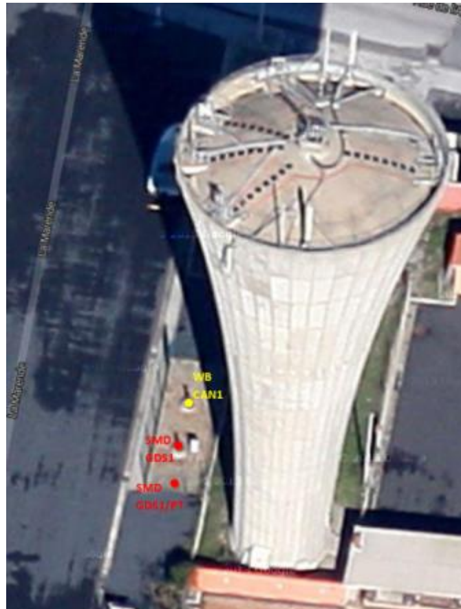
ILLUSTRATION 20 : EMPLACEMENT DES INSTRUMENTS EN FORAGE SUR LE SITE DE CANET EN ROUSSILLON (D'APRES GOOGLE MAP ; MAPS.GOOGLE.FR)
