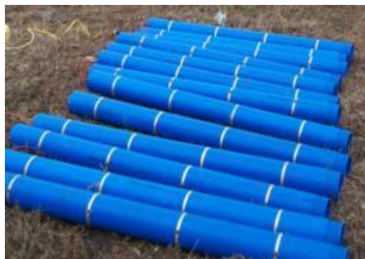
ILLUSTRATION 2 : ELEMENTS DU SMD PVC AVEC ELECTRODES DOREES (PHOTO ©IMAGEAU)
