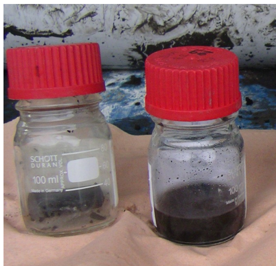
FIGURE 18 - FLACON D'EXTRACTION AVEC LE MÉTHANOL ET LE SOL (SOL DANS LE FLACON DE GAUCHE, SOL ET MÉTHANOL DANS LE FLACON DE DROITE)
