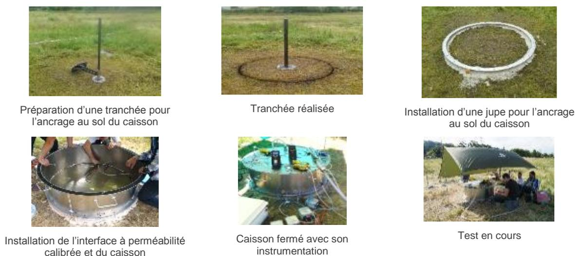
**Figure 9 : Présentation des étapes d'installation du caisson sur site.**
