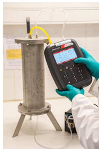
Figure 11 – Mesure respirométrique en sortie d'une colonne de sol (Source : SUEZ REMEDIATION)
