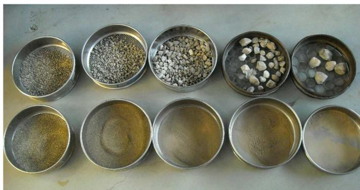
Figure 43 – Exemple de fractions tamisées d'un échantillon de sol (source PROVADEMSE)
