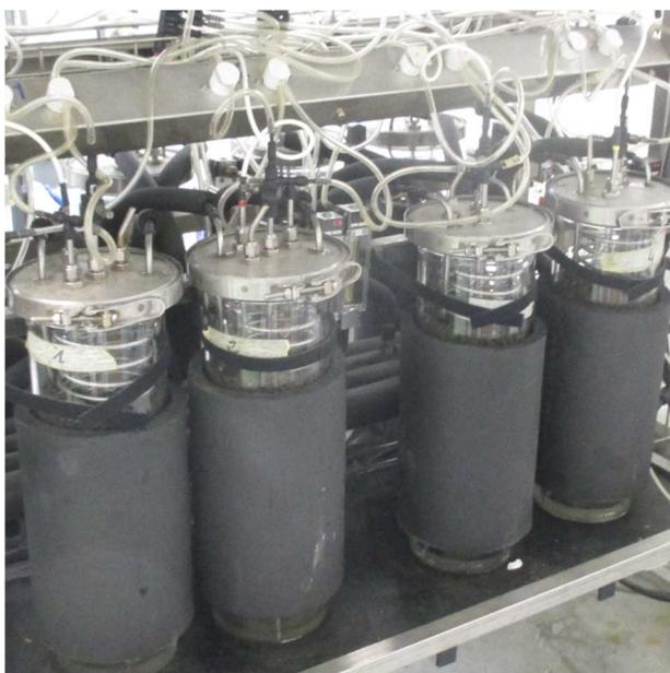
Figure 40 – Exemple de dispositif d'essai de biodégradation en réacteur (source PROVADEMSE)
