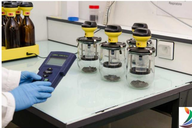
Figure 39 – Exemple de dispositif d’essai de respirométrie (source PROVADEMSE)
