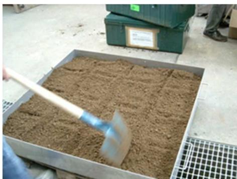
Figure 10 - Quartage d'un sol avant réalisation d'un essai en laboratoire (Source : VALGO)
