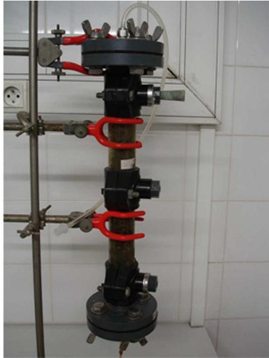
Figure 37 – Exemple de colonne de lavage de sol (SUEZ REMEDIATION)
