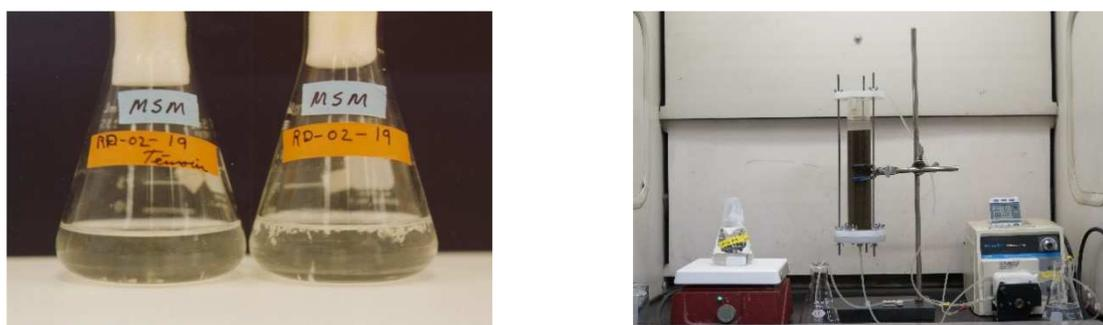
Figure 23 – Essai en réacteur agité (à gauche) et essai en colonne (à droite, source : BIOGENIE)
