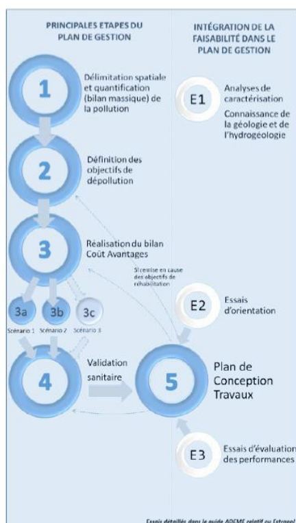
Figure 3 - Logigramme relatif au Plan de conception des travaux (source : guide PCT (Billard et al., 2019))
